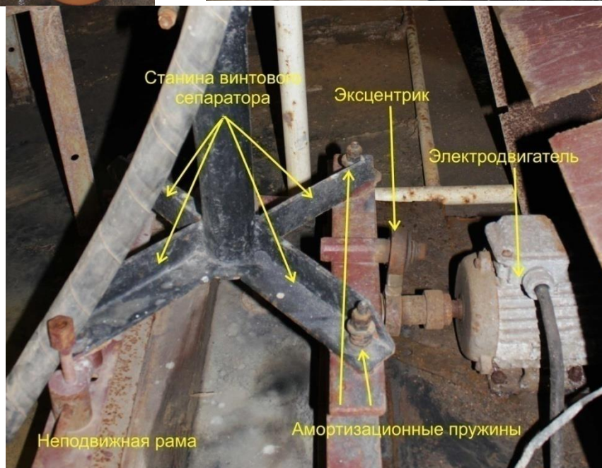
13 сурет – Екібастұз көмірінің күлқож қалдықтарына технологиялық сынақтар жүргізу кезінде пайдаланылған, діріл механизмімен толықтырылған сериялы шығарылатын бұрандалы сепаратор. А-статикалық жағдайда, Б-жұмыста (қара-магнетит), в-діріл механизмі
