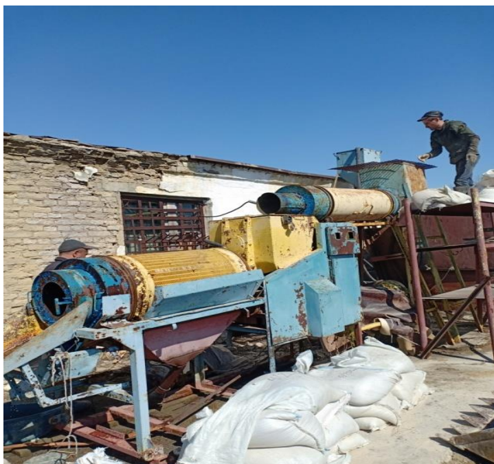
18-сурет-Екібастұз көмірінің күл-шлак қалдықтары материалын скруббер – бутарда дезинтеграциялаудың және жіктеудің технологиялық процесі
