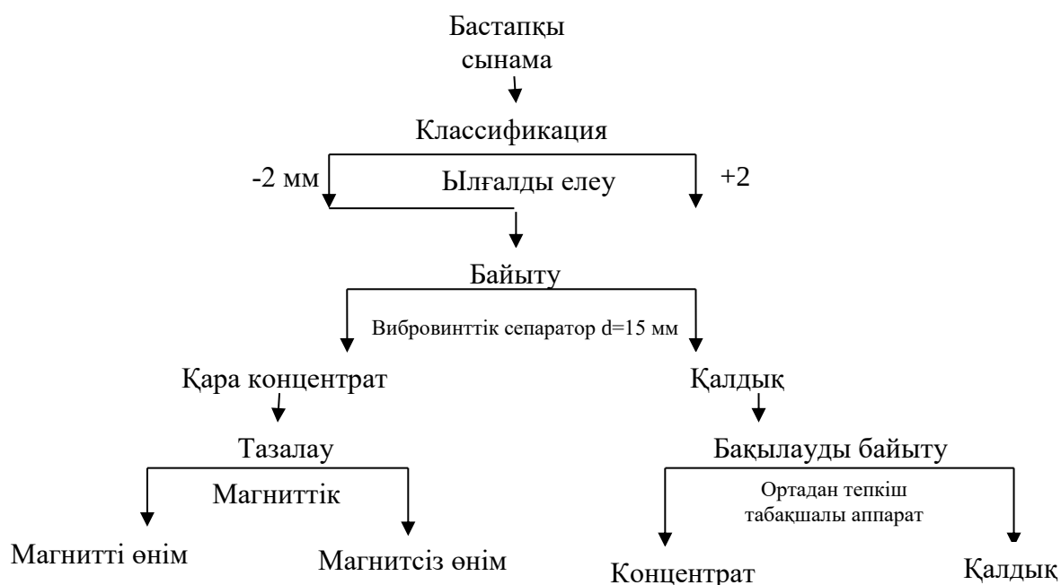
34-сурет-темірге ірілендірілген зертханалық сынақтар жүргізудің технологиялық схемасы 18-кесте-Екібастұз көмірінің табиғи ірілік материалындағы Fe күл-қож қалдықтарына ірілендірілген-зертханалық сынақтардың нәтижелері
