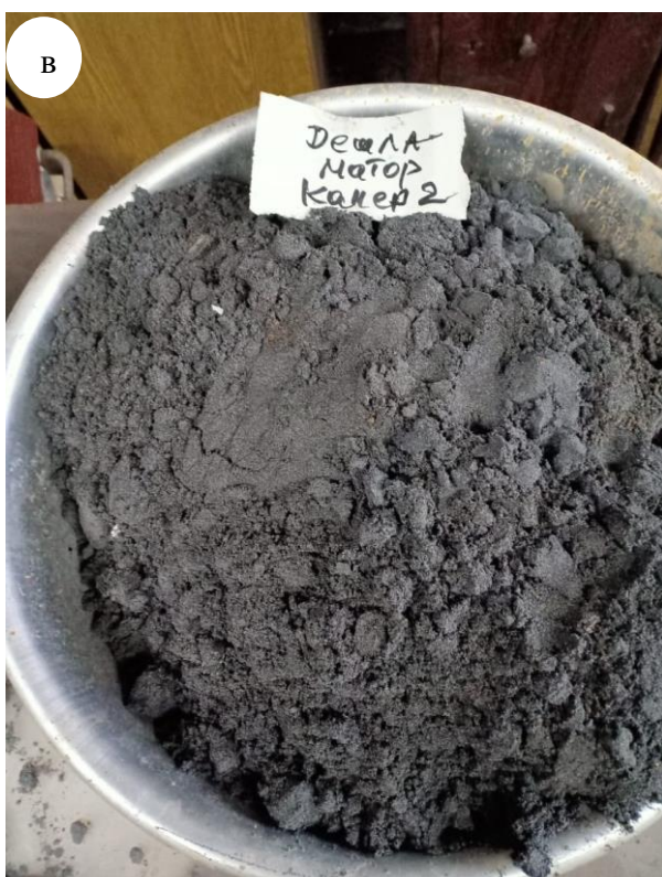
а-дірілді сепаратор концентраты, Б - №1 аэрогидродешламатордың камералық өнімі (ірі-орташа түйіршікті материал), в - №1 аэрогидродешламатордың камералық өнімі( ұсақ түйіршікті материал), г- жұқа дисперсті материал (дешламаторды ағызу) 35-сурет-алынған байыту өнімдерінің жалпы түрі
